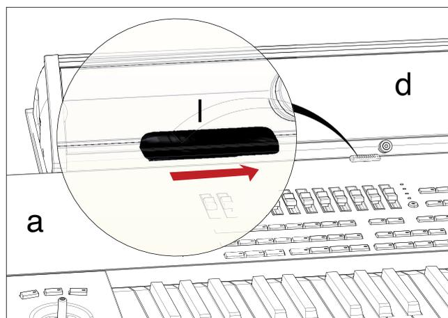
*Utilizzate il cursore SPEAKER LOCK (l) accanto al display per bloccare (e in seguito sbloccare) il sistema di amplificazione (d). Una volta bloccato, dovrete vedere l'icona del lucchetto chiuso (🔒). In questo modo il sistema (d) viene saldamente assicurato allo strumento (a).*
