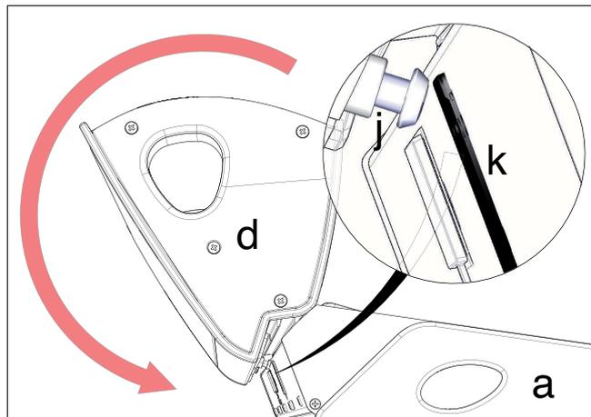
*Dopo aver allineato correttamente il modulo (d) con gli stop/delimitatori, e aver verificato che il pin di ancoraggio (j) sia in corrispondenza del foro (k) sul retro dello strumento (a), ruotate il modulo (d) per far entrare il pin (j) nel foro (k).*
