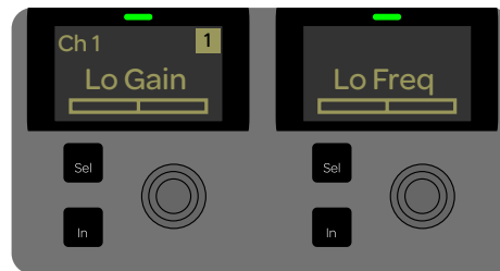
Channel Control display showing the Lo band EQ parameter
