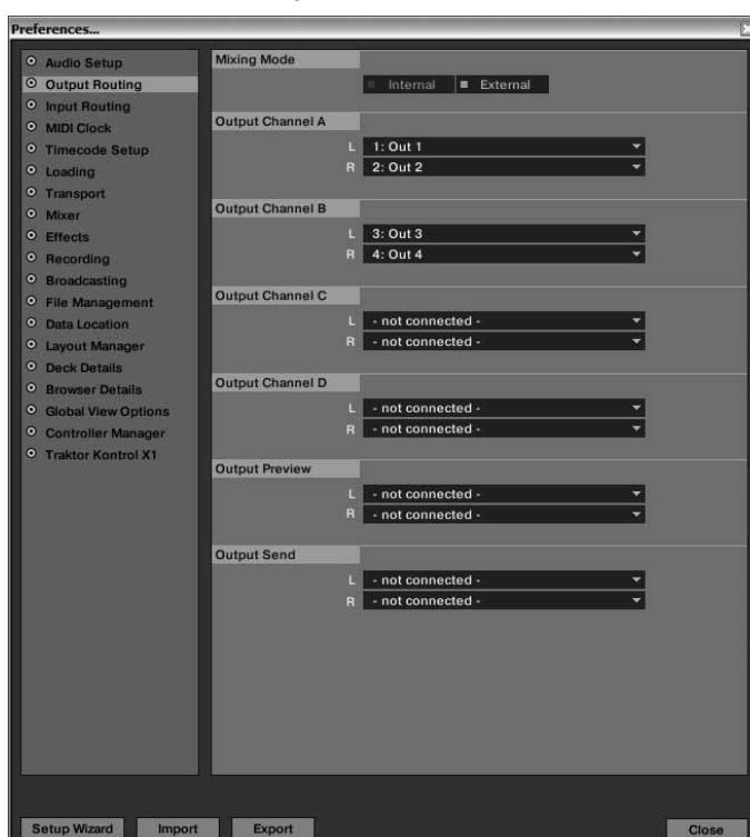
Sur l'IQ2 MIDI, régler le canal A sur „USB1“ et le canal B sur „USB2“ avec le sélecteur du signal d'entrée -6-. Les canaux virtuels de Traktor sont alors routés vers les canaux de la console de mixage.
