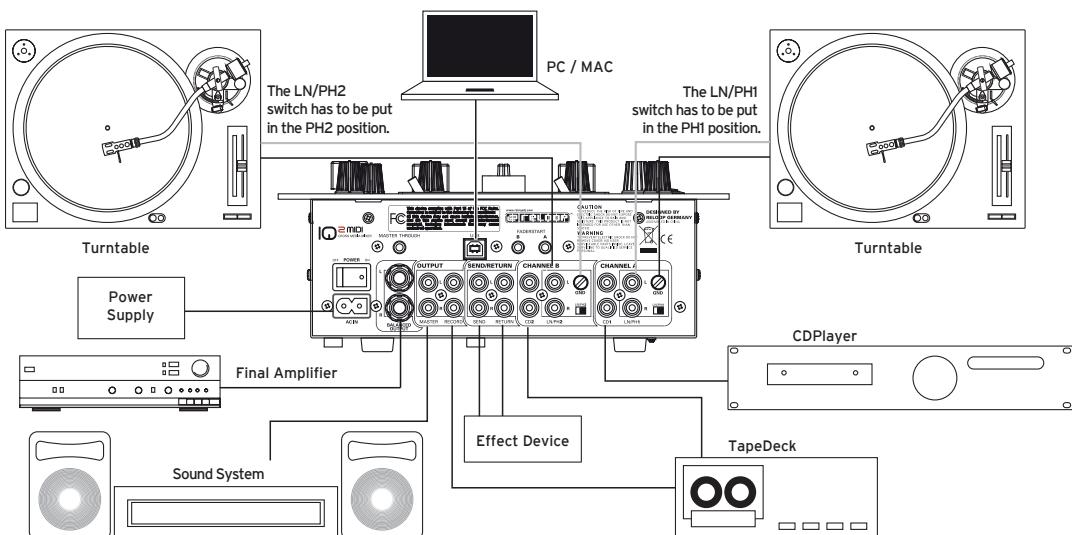
La console Reloop IQ2 MIDI est équipée d'une interface audio professionnelle intégrée avec 24 bits/96 kHz. L'utilisation d'une carte son PC externe ou intégrée n'est donc pas nécessaire. Veuillez trouver ci-dessous une liste des branchements pouvant être réalisés :
