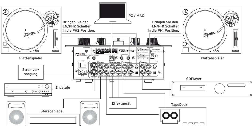
Der Reloop IQ2 MIDI besitzt ein integriertes professionelles Audio-Interface mit 24-bit/96 kHz. So mit ist eine weitere externe oder integrierte PC-Soundkarte nicht nötig. Im Folgenden finden Sie eine Auflistung der Anschlüsse, die Sie vornehmen können:
