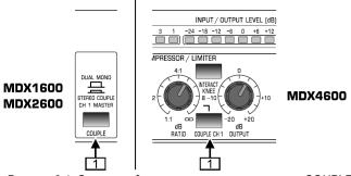
Рисунок 2.1: Связь между каналами переключателем COUPLE
