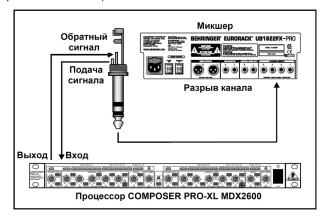
Рисунок 4.1: Подключение динамического процессора в разрыв цепи канала
