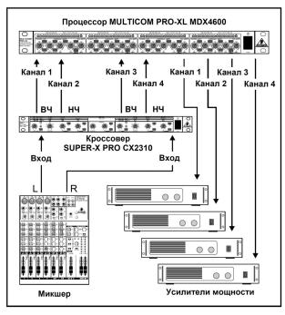
Рисунок 4.3: Многополосная компрессия с использованием процессора MDX4600
