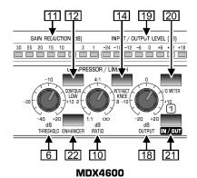
Рисунок 2.3: Элементы управления секции компрессора
