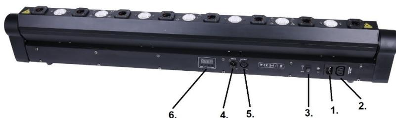
1. **POWER IN:** входной разъем питания IEC переменного тока с предохранителем BDGP 5\*20мм,2А.
