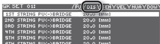
4. Кнопками [▲] [▼] выберите струну, и для каждой струны укажите расстояние от центра сегментного датчика до бриджового седла.
