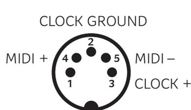
**MIDI/CV-clock input wiring diagram**
