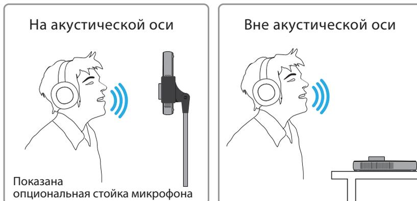
Встроенный микрофон ONE спроектирован таким образом, что обеспечивает чистый четкий звук, даже когда ONE просто лежит на столе и источник звука находится вне акустической оси (то есть источник звука находится не под оптимальным углом по отношению к верхней панели ONE). Изменяя угол расположения ONE относительно источника сигнала, можно кардинальным образом улучшить качество снимаемого микрофоном сигнала.
