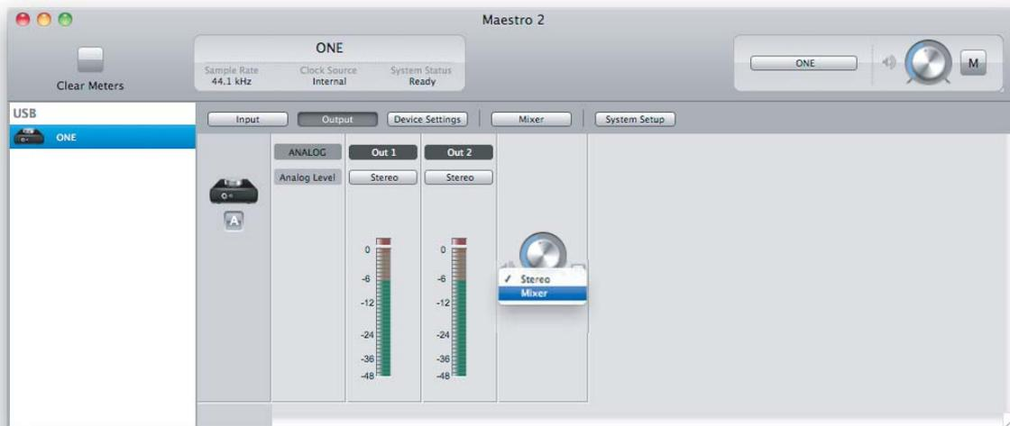
После того как будет выбран источник входного сигнала и отрегулирована чувствительность входа, на измерителях Input и Mixer Master начнет отображаться уровень сигнала. Если загораются индикаторы перегрузки по входу (секция Input), уменьшите чувствительность входа в окне Control приложения Maestro. Если загораются индикаторы перегрузки микшера Maestro (секция Mixer Master), приберите фейдер секции Input.
