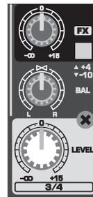
Рис. 2.6: FX Send/Balance/Level-регулятор
