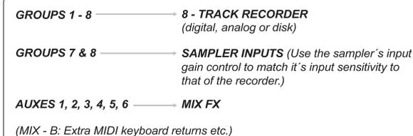
Fig. 14.1: Send routing
