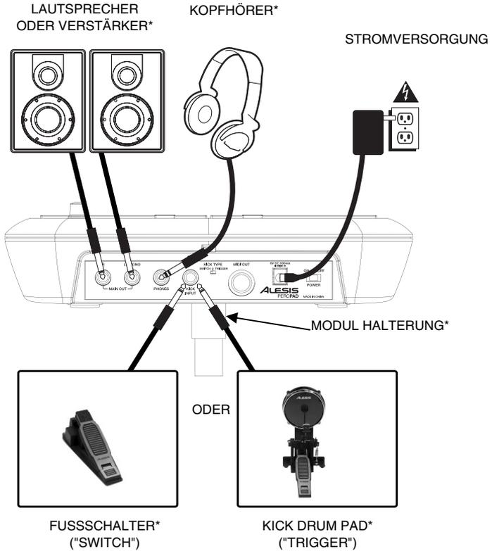
**WARNUNG:** Schalten Sie PercPad ZUERST ein und setzen Sie erst danach die Kopfhörer auf bzw. schalten die Lautsprecher ein.
