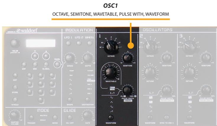
**Octave:** il range va da 64 a 1' (7 ottave), si noti che l'altezza standard di un pianoforte è riferita a 8' e questo significa che, impostando il controllo relativo alla posizione centrale, un tasto qualsiasi della tastiera suona con la stessa frequenza che suonerebbe su pianoforte standard (*nota: la tastiera dello Sledge va da C2 a C7 mentre il Pianoforte tradizionale va da A0 a C8*)
