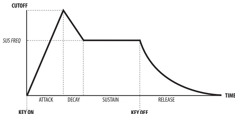
**Attack:** determina il tempo che impiega il filtro per raggiungere la massima frequenza di taglio, che è determinata anche da altri parametri (rif: cutoff, tracking, amount ecc).
