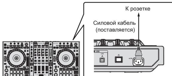
6 Нажмите переключатель [I] на задней панели данного аппарата и включите питание данного аппарата.
