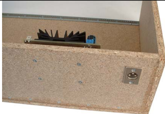
Detailansicht von hinten (mit XLR-Steckverbindung)
